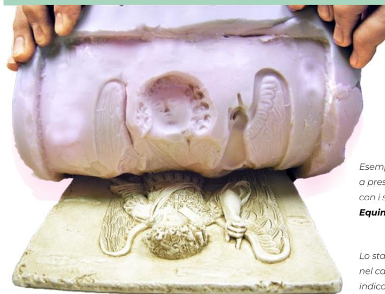
Esempi di stampi a pressione realizzati con i siliconi in pasta **Equinox** e **Poyo Putty**.
