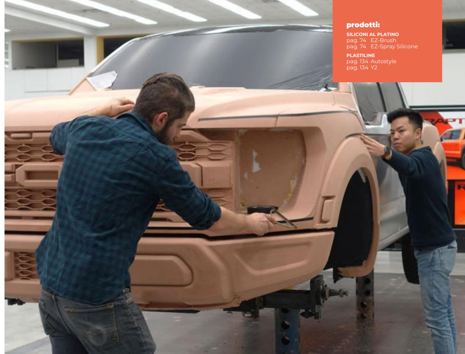
Design della carrozzeria di un pick-up studiato tridimensionalmente tramite la modellazione della plastilina **Autostyle**.
