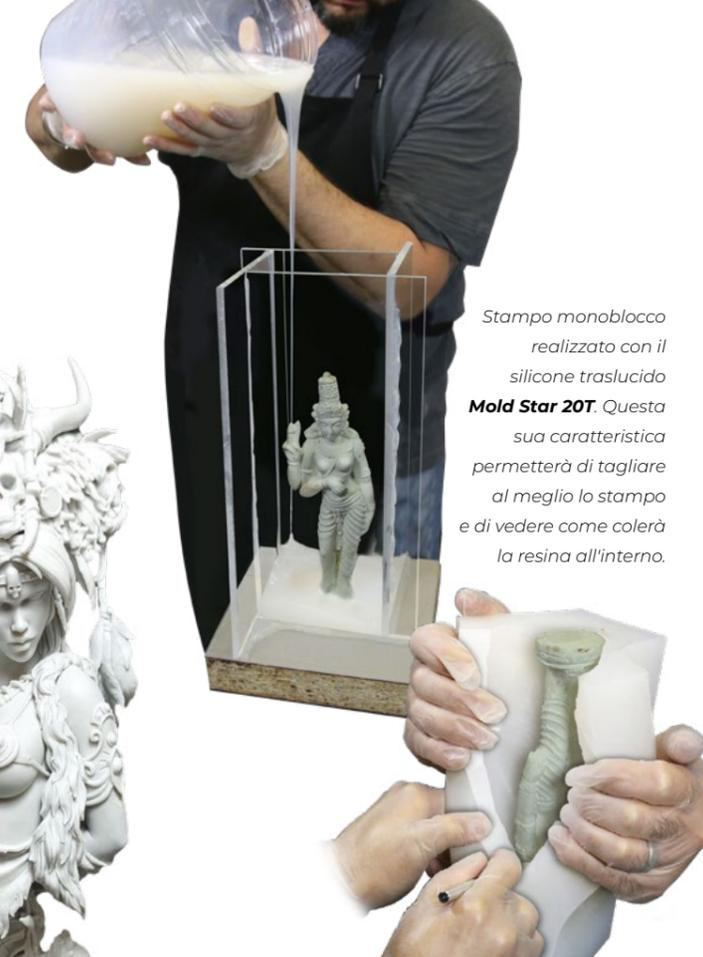
Stampo monoblocco realizzato con il silicone traslucido **Mold Star 20T**. Questa sua caratteristica permetterà di tagliare al meglio lo stampo e di vedere come colerà la resina all'interno.
