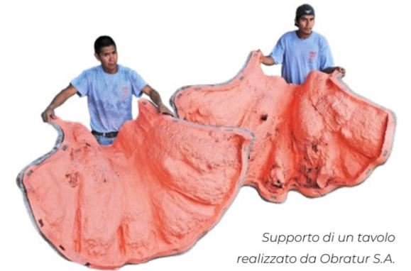
Supporto di un tavolo realizzato da Obratur S.A. di Cacun con il silicone a pennello **Rebound 25** e il cemento **GFRC**.
