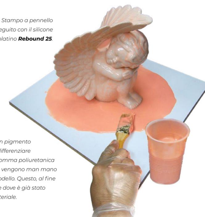
L'aggiunta di un pigmento permetterà di differenziare i vari strati, di gomma poliuretanicca e siliconica, che vengono man mano applicati sul modello. Questo, al fine di comprendere dove è già stato applicato il materiale.
