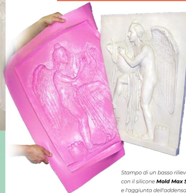
Stampo di un basso rilievo realizzato con il silicone **Mold Max STROKE** e l'aggiunta dell'addensante **Thi-vex**. Aggiungendo l'addensante è possibile applicare i prodotti anche su superfici verticali.
