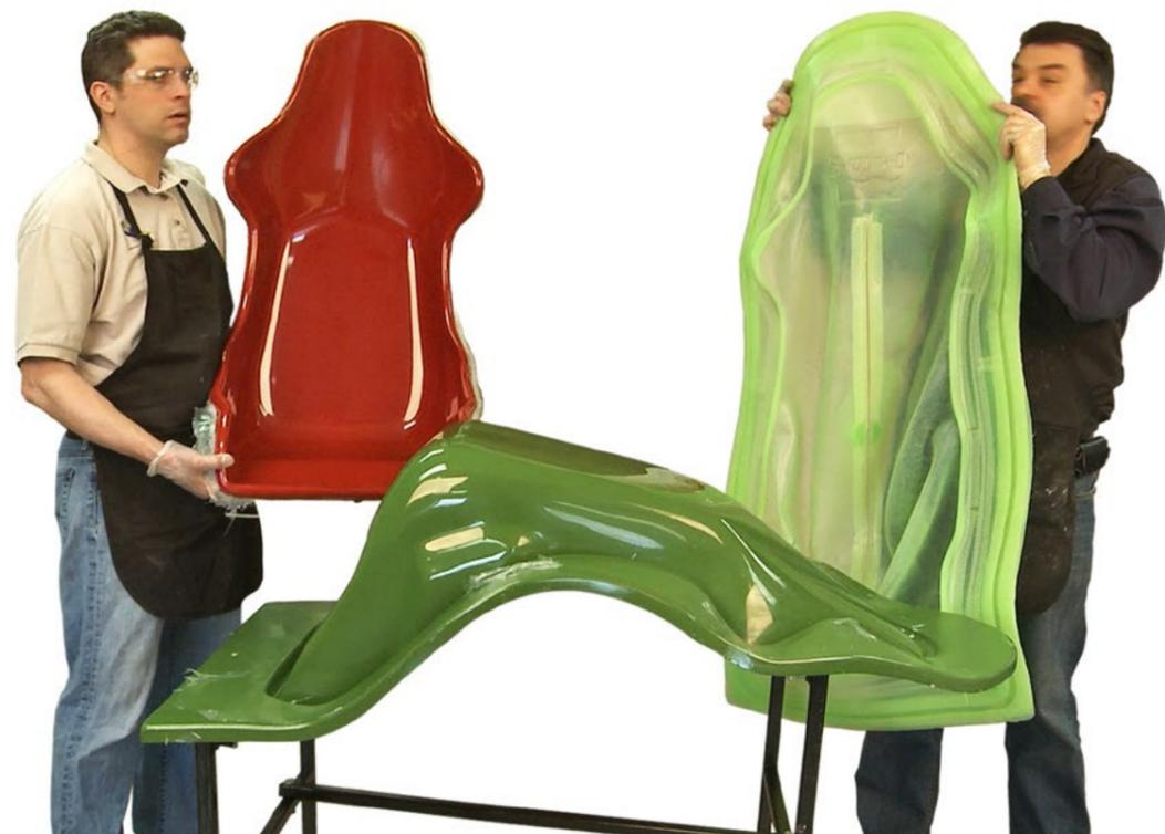
Sacco da vuoto di un sedile realizzato con **EZ-Spray Silicone 20**. Una volta posizionato sul modello sarà facile impregnare il tessuto di vetro sottostante con una resina da infusione.
