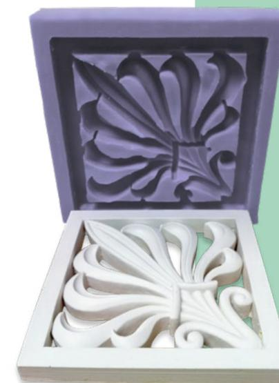
Vari esempi della tipologia di stampo a cielo aperto, la più comune e la più semplice da realizzare. I siliconi impiegati in questo caso sono **Mold Max 29 NV**, **Mold Max 30**, **Mold Star 16 FAST** e **Smooth-Sil 945**.
