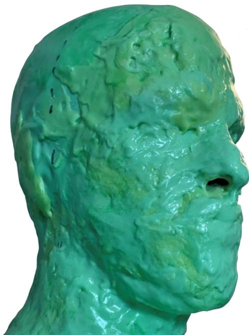
Calco del viso realizzato con l'alginato **Acrobat** in cui è stato colato successivamente del gesso. Questa tipologia d'alginato è caricata con fibre che ne permettono l'applicazione verticale.
