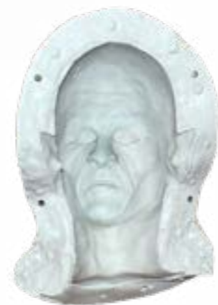
In assenza di sottosquadra o nel caso di manufatti realizzati in silicone, è possibile creare stampi rigidi con le resine poliuretanicche Smooth-cast e Shell Shock .
