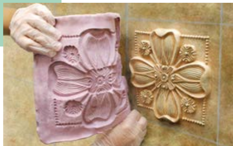
Stampo a pressione realizzato con il silicone Poyo Putty preso direttamente sul dettaglio da riprodurre.
