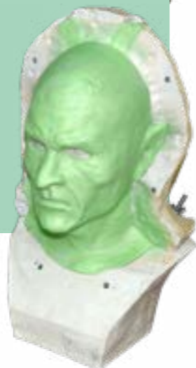
In assenza di sottosquadra o nel caso di manufatti realizzati in silicone, è possibile creare stampi rigidi con le resine poliuretanicche Smooth-cast e Shell Shock .
