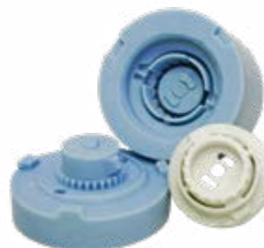
Lo stampo bivalva, può essere semplice o complesso. Dipende se si ha o meno la necessità di riprodurre i dettagli di un oggetto anche al suo interno, come nel caso di questa parte di macchinario.
