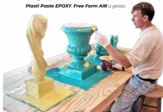
L'aggiunta di un pigmento permetterà di differenziare i vari strati, di gomma poliuretanicca e siliconica, che vengono man mano applicati sul modello. Questo, al fine di comprendere dove è già stato applicato il materiale.
