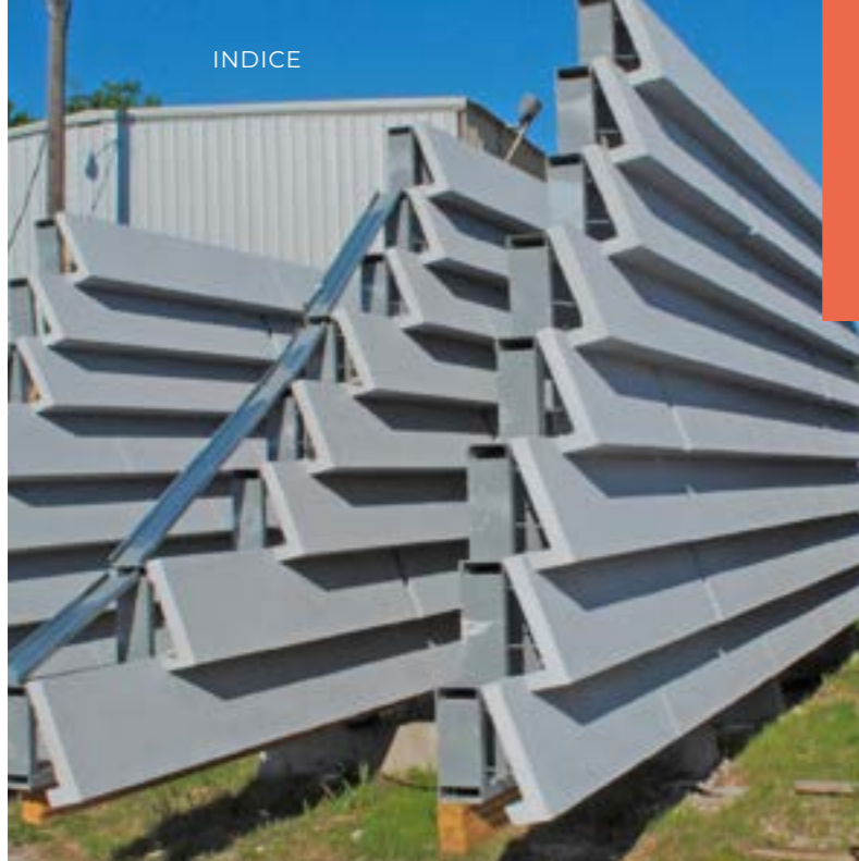
Pannelli molto sottili realizzati a spruzzo da GFRC Cladding Systems nel Texas con la miscela GFRC , il polimero Forton VF-774 e il rinforzo di fibre di vetro AR .
