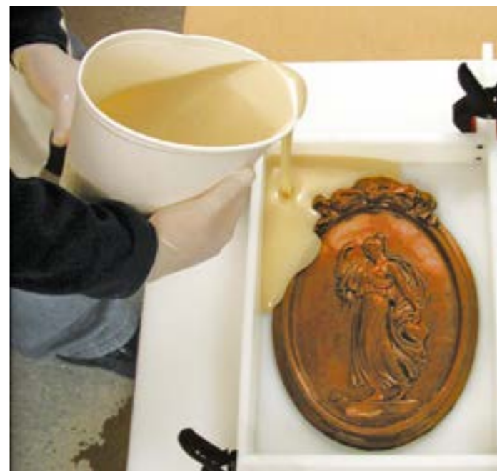
Stampi realizzati con la gomma poliuretatica autodistaccante Reoflex WET .
